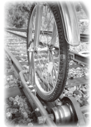
線路を走行する仕組み
